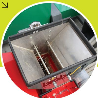
Rotateur de dosage très précis pour une alimentation continue et homogène aux points de distribution.
