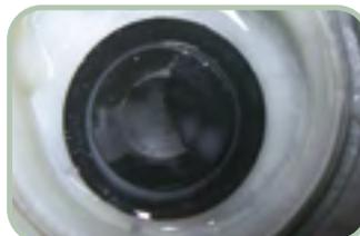
Dépôt de membrane **inexistant** sur le corps du piston.
