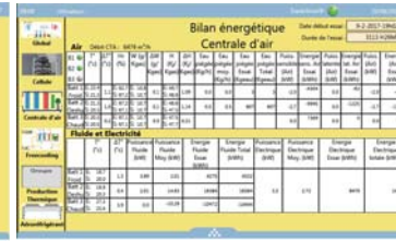
Bilan énergétique centrale d'air
