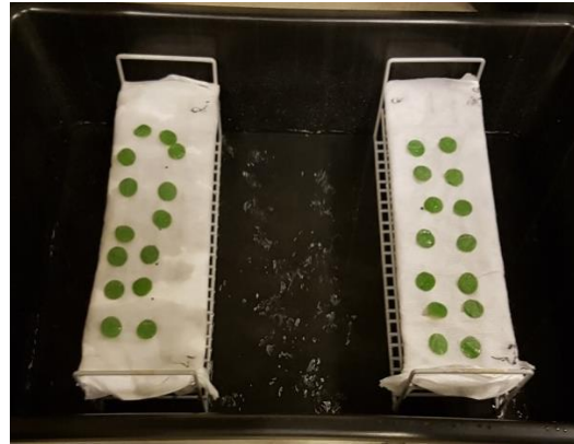
Fig. 2 : bac contenant les disques de feuilles placés sous le simulateur de pluie
