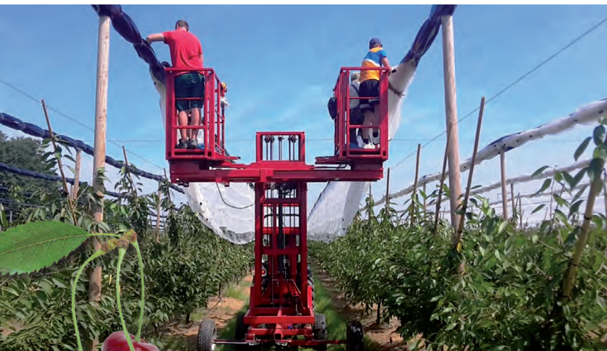
Le VOEN „Covermaster“ - la machine polyvalente pour le boudinage des bâches VOEN
